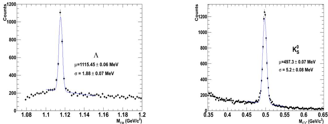
**Abbildung 4: Histogramme für invariante Massen aus V0-Zerfällen**
