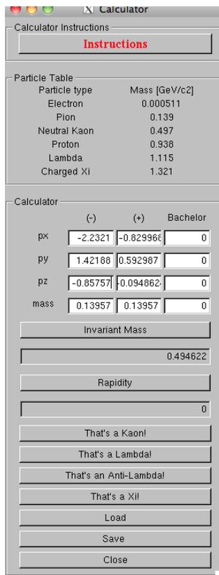
**Abbildung 9: Rechnerfenster zur Berechnung der invarianten Masse**
