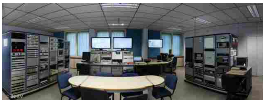
Laboratorio di tempo dell'INRIM, che contribuisce a generare la scala di tempo internazionale detta Tempo Universale Coordinato (UTC) e dal quale viene diffuso il segnale orario a tutta l'Italia
